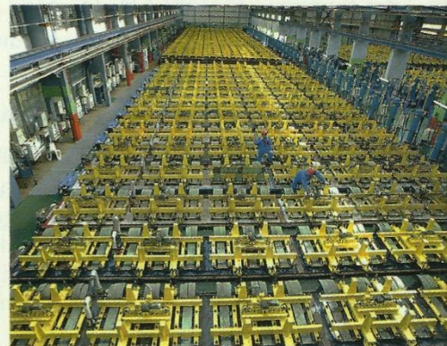
Doc. 10 Électrolyse industrielle de solutions de chlorure de sodium à 300 g . L -1 (saumure). Les anodes sont en titane recouvert d'oxydes de titane et de ruthénium ; les cathodes sont en acier ou en nickel. L'intensité du courant continu est voisine de 50 kA.
